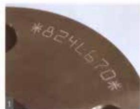
Normované značení typu OCR-A do oceli
