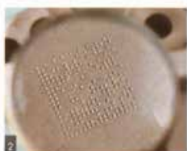
Značení datamatrix kódu
