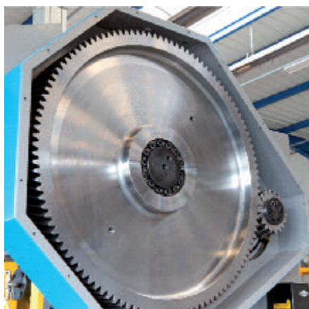
Pohled na ozubené hnačí kolo lisu 80t
