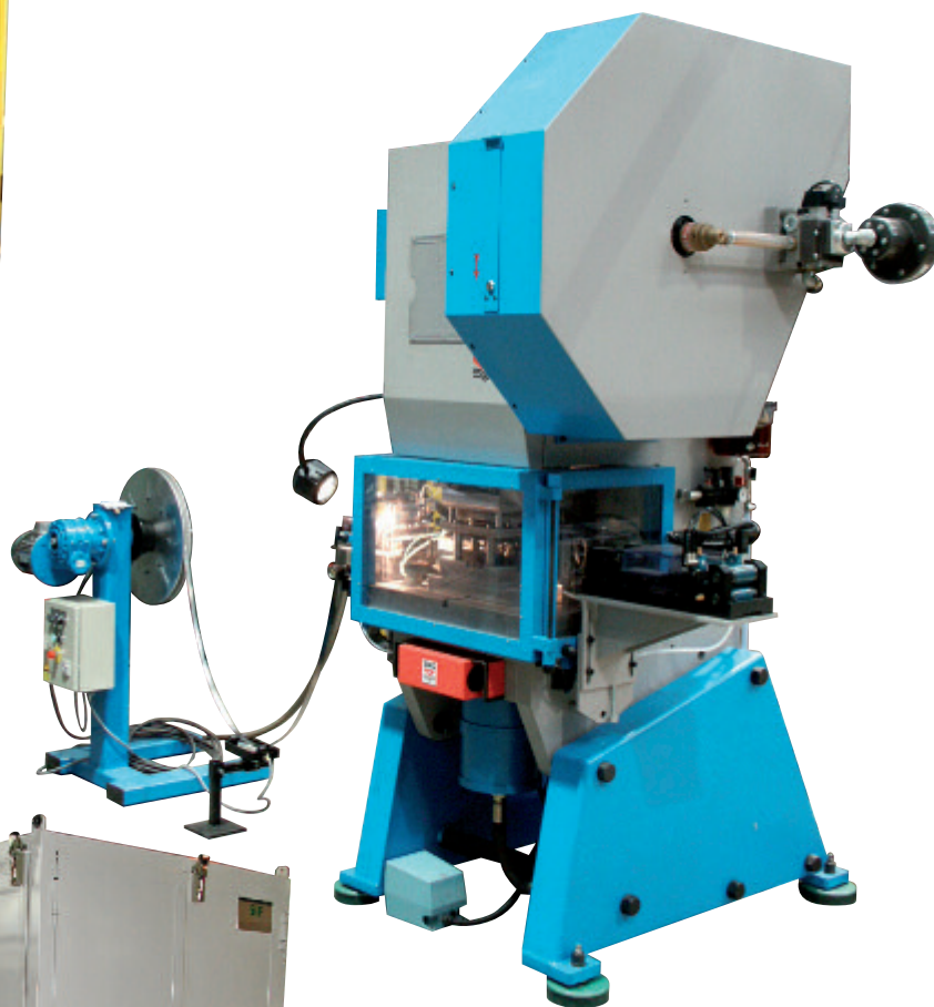
Řezací linka zahrnující odvíječ, lis 45T a podavač pásu
