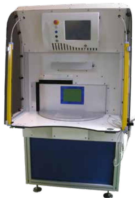
Standardní pracoviště s 2. pozicovým rotačním stolem
