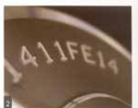
Značení sériového čísla na ocelový dílec
